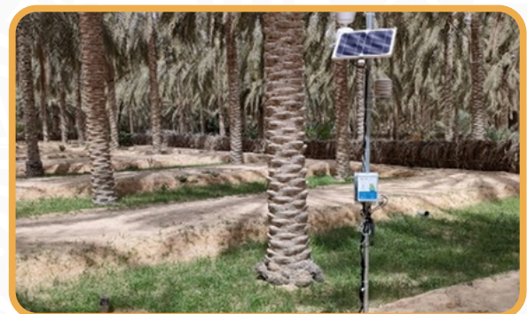
Photo : sonde de contrôle de l'irrigation couplée à une station météo à Kébili (Tunisie)
